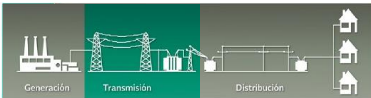
Figura 2.2.1: Sistema Eléctrico Interconectado (Generación, Transmisión, Distribución)
